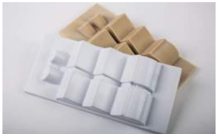
4 Изделия, произведенные вакуумной формовкой по оснастке из керамонаполненного пластика PLASTCure Rigid 10500. Оснастка напечатана по технологии MOVINGlight®
