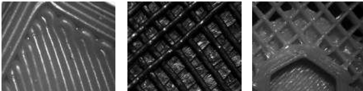
Рис. 5 | Поперечные срезы печатаемых моделей с различными внутренними заполнениями слоя
