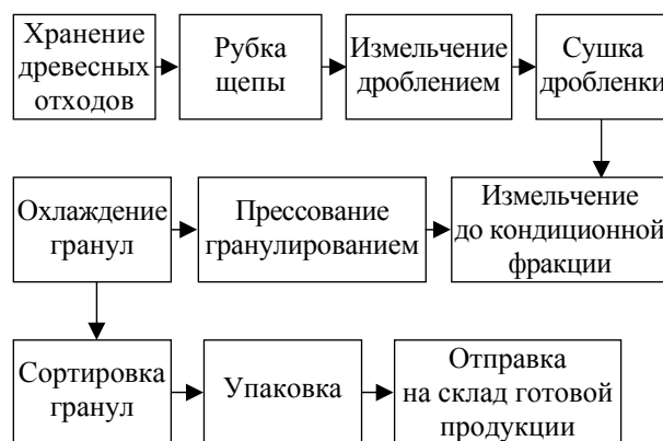
Последовательность выполнения операций при производстве топливных гранул с использованием древесины лиственных пород
