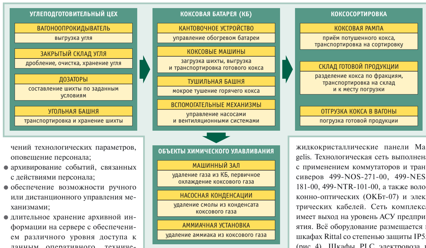
Рис. 2. Архитектура системы управления объектами комплекса
