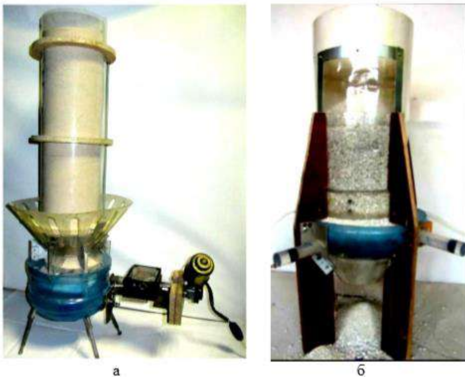
Рисунок 1 – Физические модели выгрузочных устройств, снабженных выгрузочными столами, совершающими плоскопараллельное перемещение относительно сечения шахты печи (а) и движение по квадратной траектории (б)
