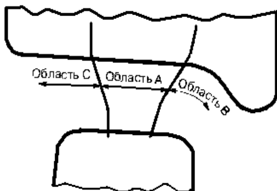
Рис. 2. Функциональные области контакта в системе колесо – рельс: контакт между центральными областями головки рельса и поверхностью катания колеса (зона А); контакт между областью выкружки головки рельса и основанием гребня колеса (зона В); контакт между внешними частями головки рельса и поверхностью катания колеса (зона С)
