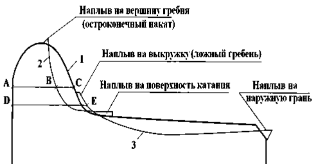
Рис. 8. Профили поперечного сечения колеса: 1 - исходный; 2 - при боковом изнашивании; 3 - при нормальном изнашивании; AC - исходная толщина гребня; AB - то же, при боковом изнашивании; DE - фактическая толщина гребня при нормальном изнашивании
