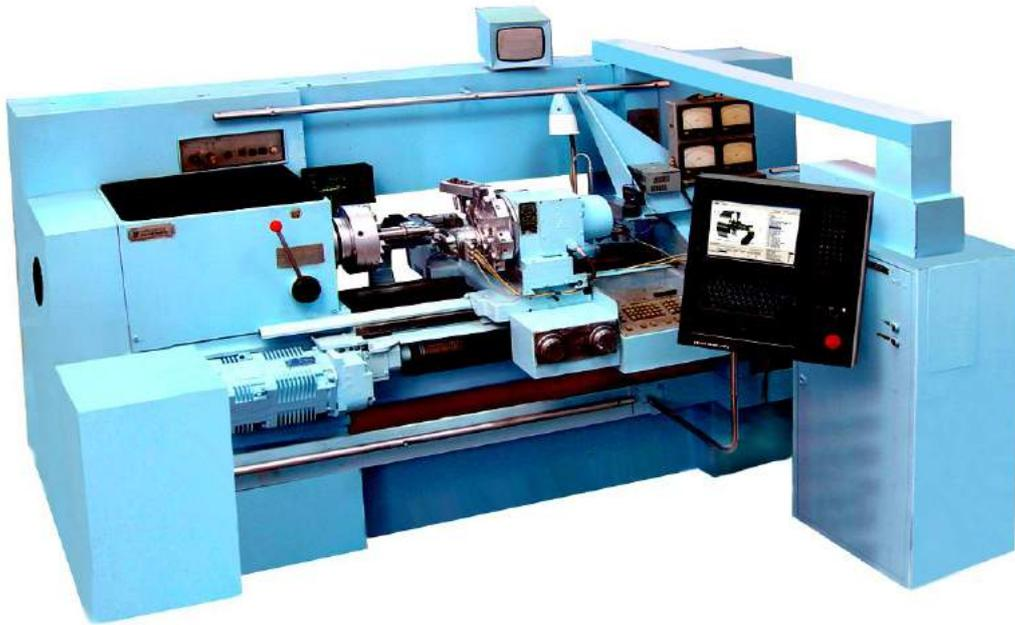
Рис. 2. Экспериментальная установка на базе токарного станка с ЧПУ
