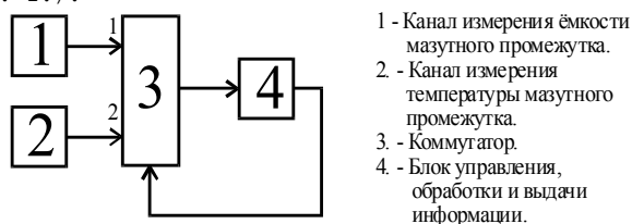
Рис. 1. Структурная схема портативного измерителя влажности мазута
