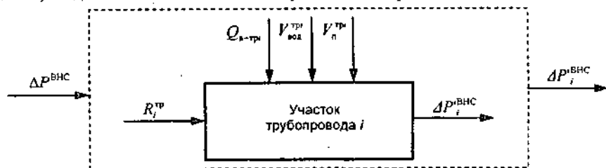
Рисунок 2 – Схема элементов газотранспортной системы шахты
