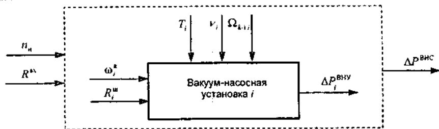
Рисунок 3 – Технологические параметры вакуум-насосной станции
