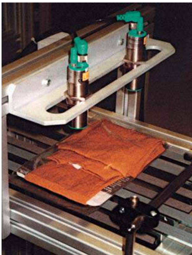
Рис. 18. Определение ориентации пакетов на упаковочной линии
