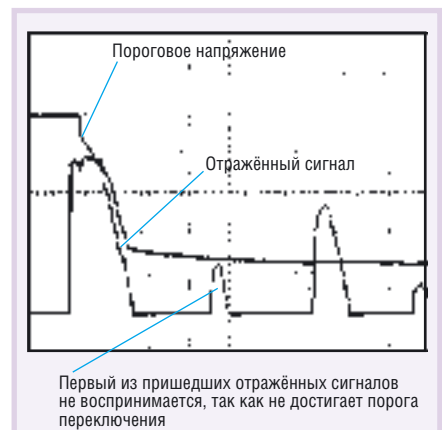
Рис. 8. Подавление отражённых сигналов от возмущающих объектов с помощью регулируемого порога переключения
