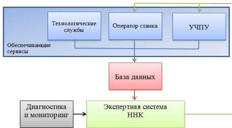
Рис. 1. Структура системы управления состоянием инструмента
