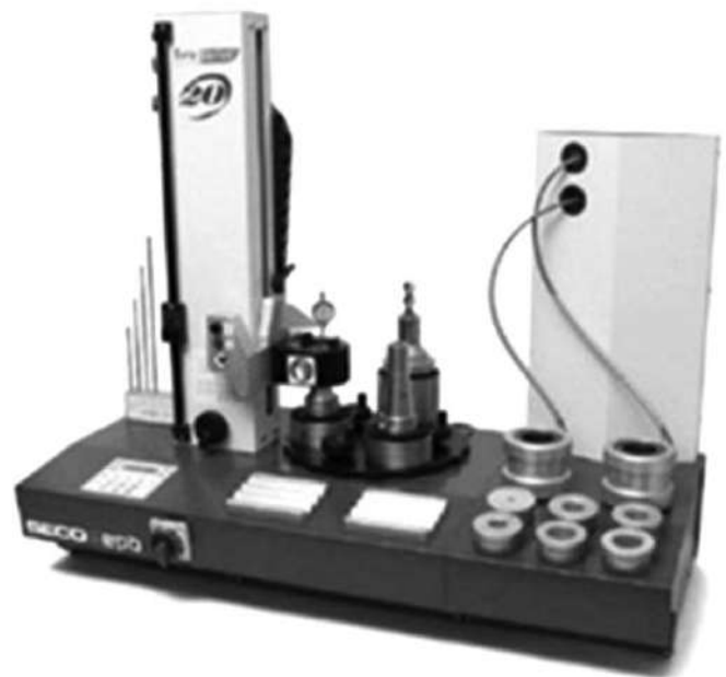
Рис. 5. Прибор для сборки термооправок EasyShrink 2.0
