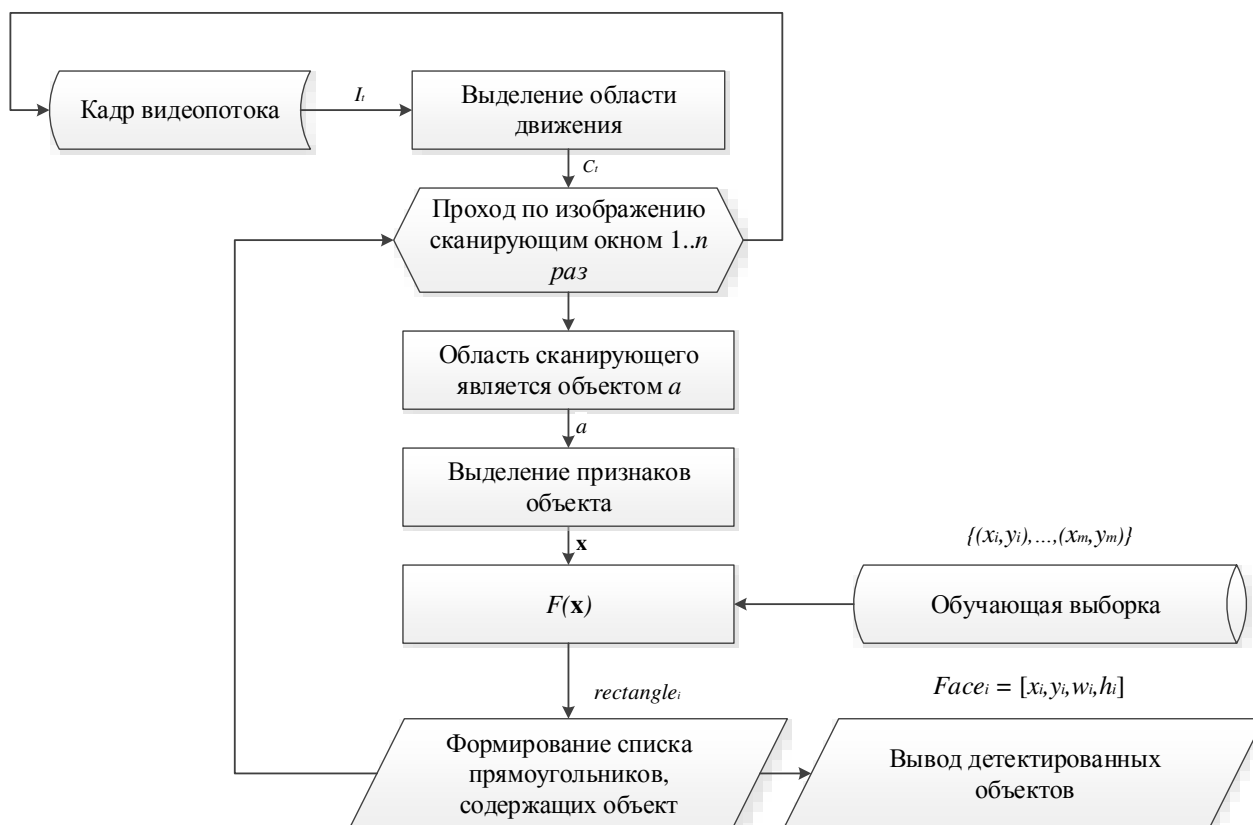
Рис. 2. Алгоритм детекции лица в видеопотоке.
