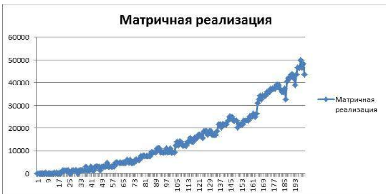
Рисунок 1. Зависимость времени выполнения (в тиках) при матричной реализации алгоритма Вагнера-Фишера от длины входного слова
