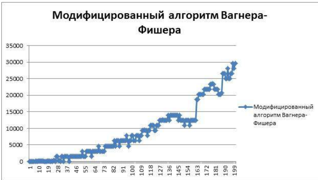
Рисунок 4. Зависимость времени выполнения (в тиках) алгоритма поиска расстояния Дамерау-Левенштейна от длины входного слова
