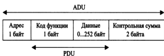
Рис. 1 – Формат кадра протокола Modbus RTU; PDU (Protocol Data Unit) – элемент данных протокола; ADU (Application Data Unit) – элемент данных приложения
