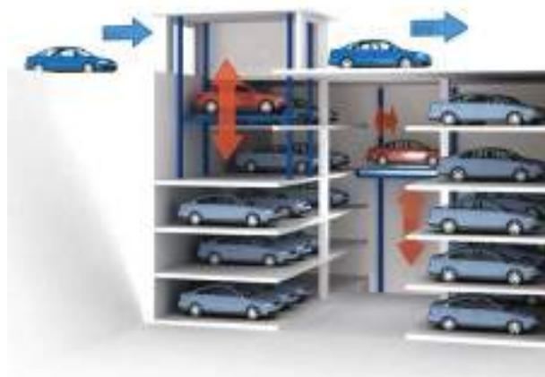
Рис. 3. Высотная МАС с шестью ММ на ярусе
