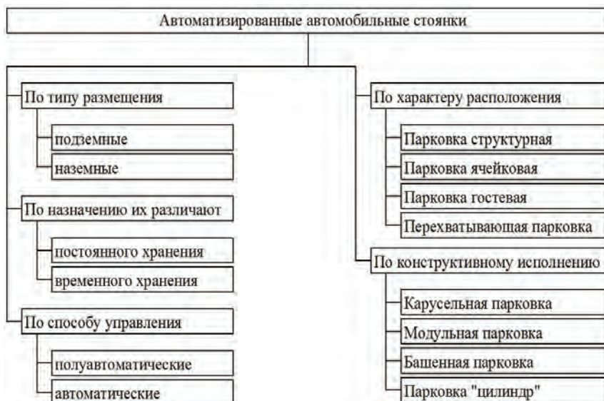
Рис. 1 - Классификация технических решений автоматизированных многоуровневых стоянок для легковых автомобилей
