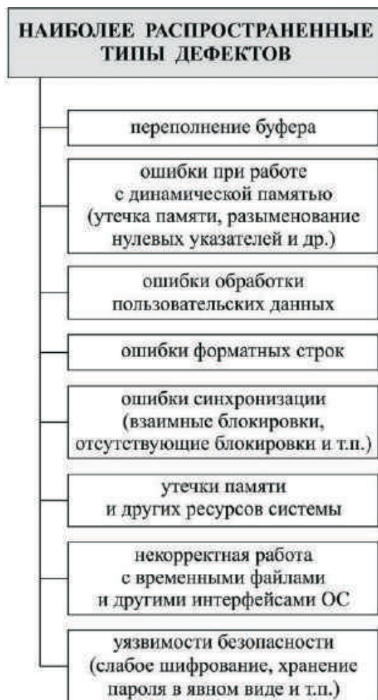
Рис. 2. Наиболее распространенные типы дефектов ПО
