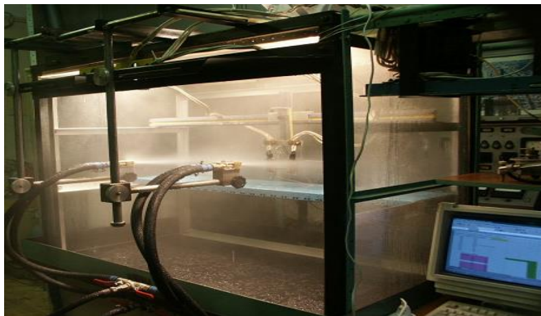
Рисунок 3б Стенд для исследования работы форсунок (узел стационарного калориметра, б – общий вид стенда)
