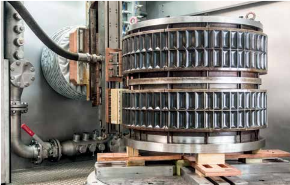
ЕСМ-обработка пресс-форм (сегментов) для брикетирования ГБЖ — удаление с поверхности около 133 кг материала
