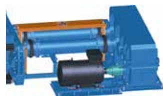
Главный привод с редуктором
