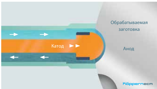
Шаг 3: Финальная обработка до требуемой глубины, полировка (при необходимости)
