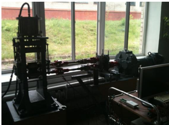
Рис. 2. Общий вид лабораторно-промышленного стана дуо 100×100
