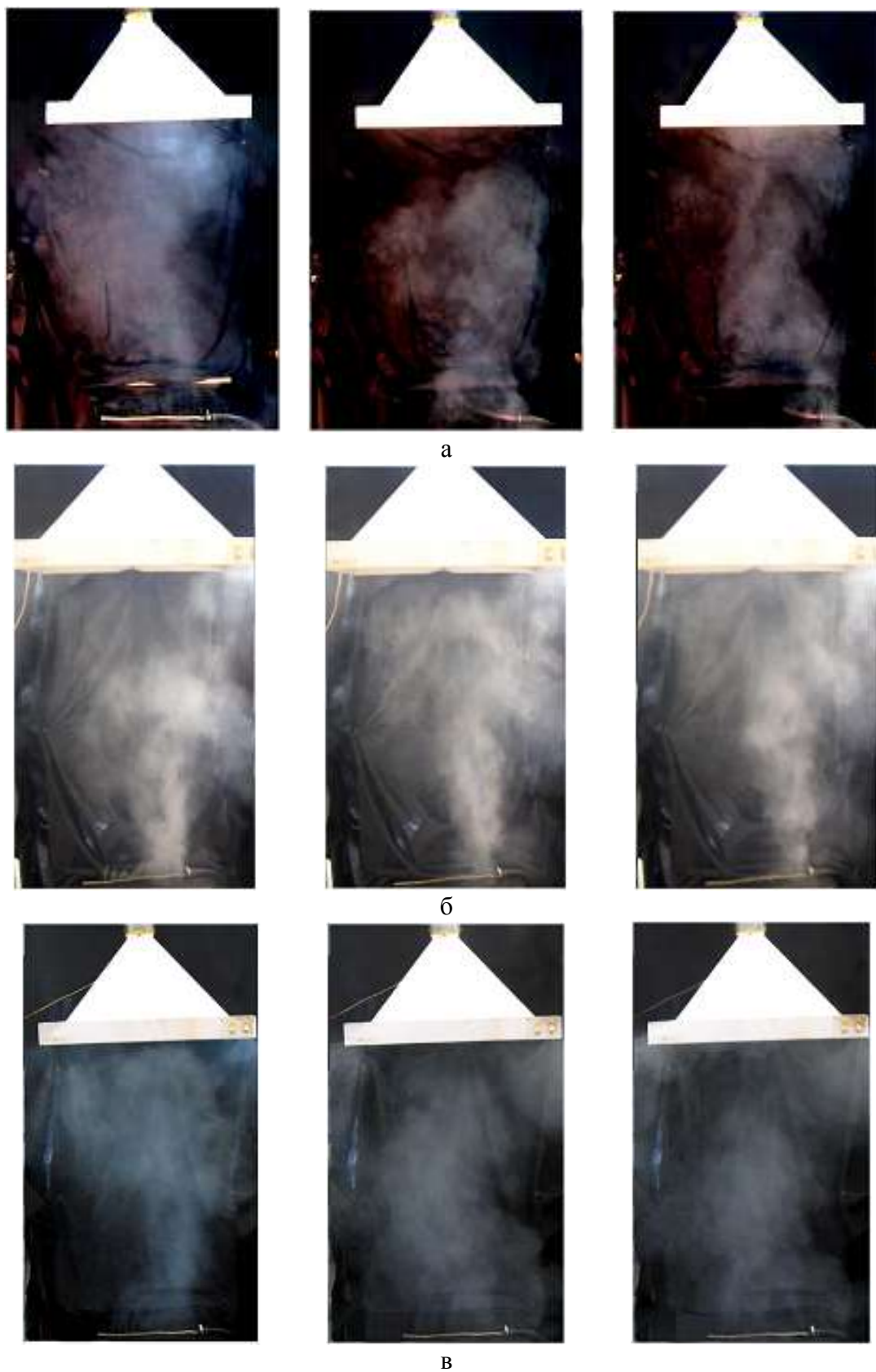
Рисунок 4 – Характерные картины газовых потоков при моделировании работы системы местной вентиляции, снабженной безлопастным (а), осевым (б) и центробежным (в) вентиляторами
