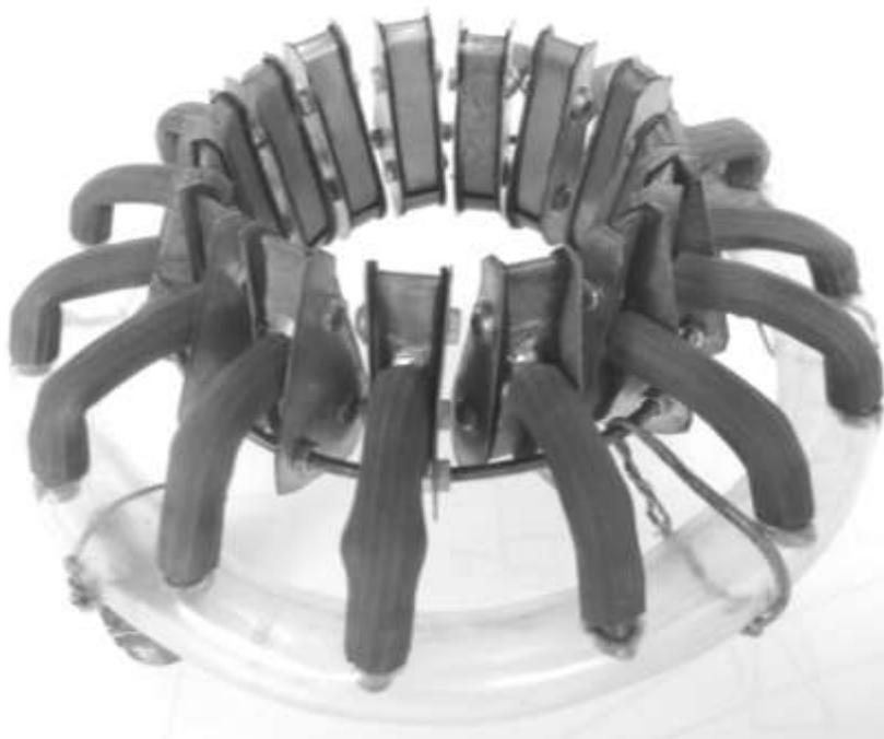
Рис.2 Действующая модель предложенного вентилятора
