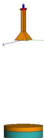
Рисунок 2- Пирамидальный рупор с центральным диском
