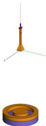
Рисунок 5 - Пирамидальный рупор с двумя отражающими зонами Френеля
