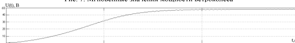
Рис. 8. Мгновенные значения напряжения на выходе выпрямителя
