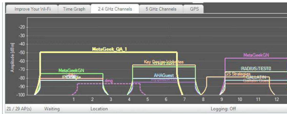
Рис. 2. Распределение Wi-Fi - источников по частотным каналам.
