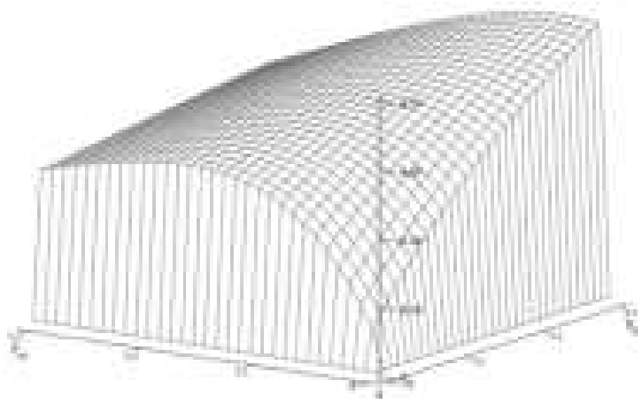
Рис.3. Область значений S_{CSMA/CA} КИПСК протокола СМД CSMA/CA при наличии «скрытых» станций ( M=3 , D=3 ) (составлено автором)
