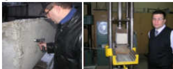
Рис. 2. Определение прочности торкрет-фибробетона монолитной железобетонной оболочки
