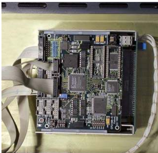
Рис. 5. Каркас 5253 с модулями CPU188-5MX и АО16-V8
