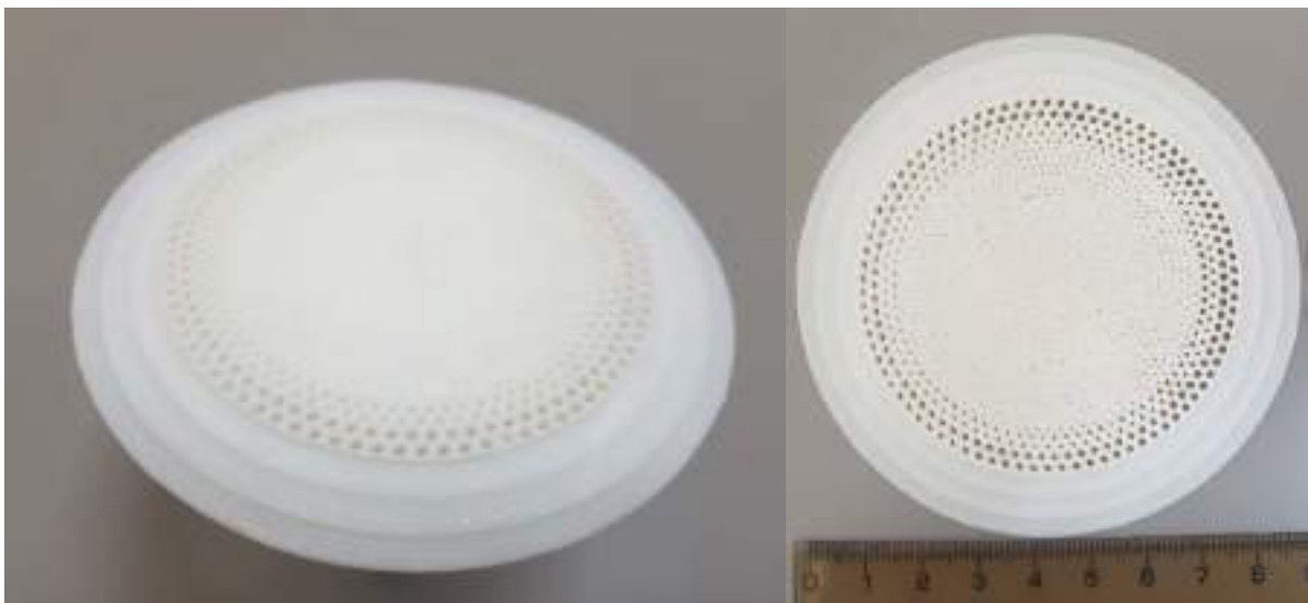
Рис. 4. Выполнение макета ЛЛ с помощью перфорации.
