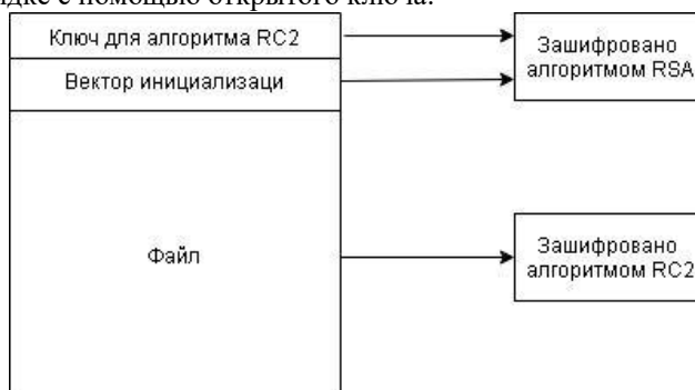
Рисунок 7– Схема шифрования файла
