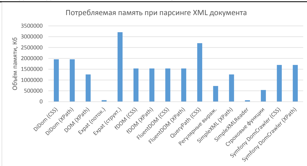
Рисунок 4 – Потребляемая память при обработке XML документа размером 159 МБ
