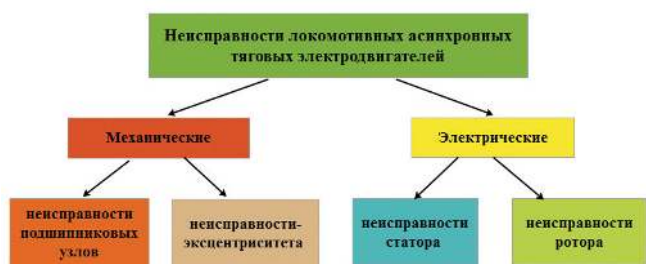
Рис. 2. Классификация неисправностей асинхронных тяговых электродвигателей
