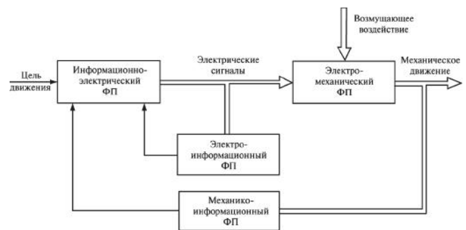
Рис. 2. Информационные и энергетические потоки в робототехнической системе:
