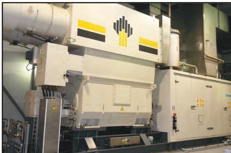
Рис.1. Общий вид газотурбинной установки SGT 300 Tempest 7,9 МВт
