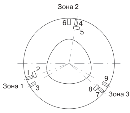
Рис. 2. Схема расположения тензодатчиков [Fig. 2. Scheme of strain gauges' arrangement]
