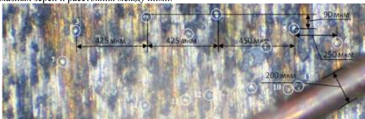
Рисунок 5 – Фотография рабочей поверхности алмазного шлифовального круга
