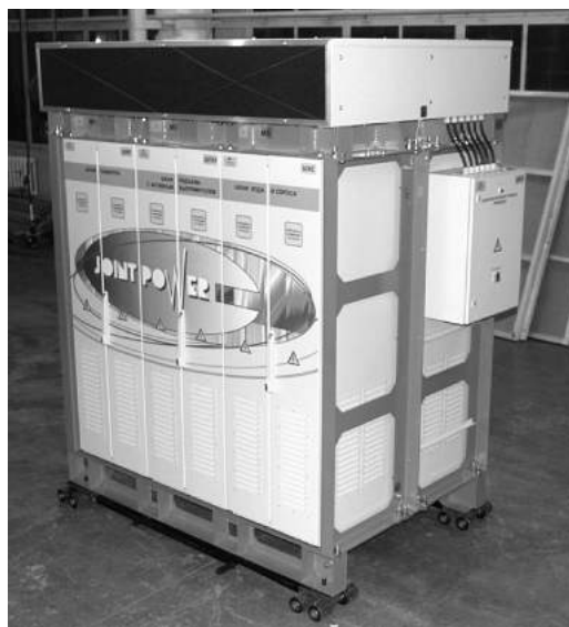
Рис. 1. Преобразователи управления электроприводами переменного тока экскаватора ЭКГ-10
