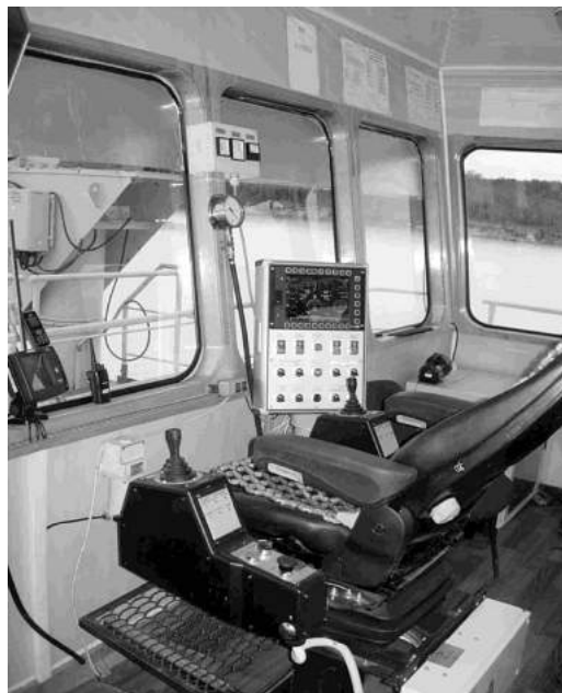
Рис. 3. Рабочее место машиниста земснаряда
