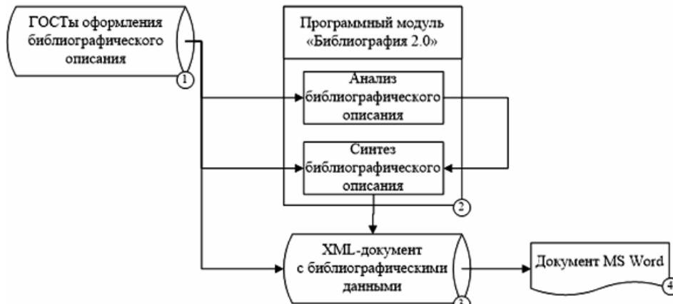
Рис. 1. Структура программного модуля для обработки библиографической информации
