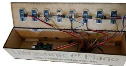
Рис. 18. Восемь датчиков HC-SR04 подключенных к модулю Octasonic 8 x HC-SR04 Ultrasonic Breakout Board вмонтированные в деревянный корпус
