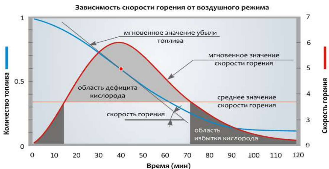
Рисунок 1 – Зависимости скорости горения от воздушного режима
