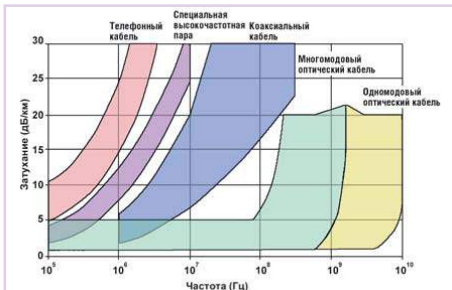
Рис. 7. Зависимость затухания от частоты передаваемого сигнала для разных типов проводников
