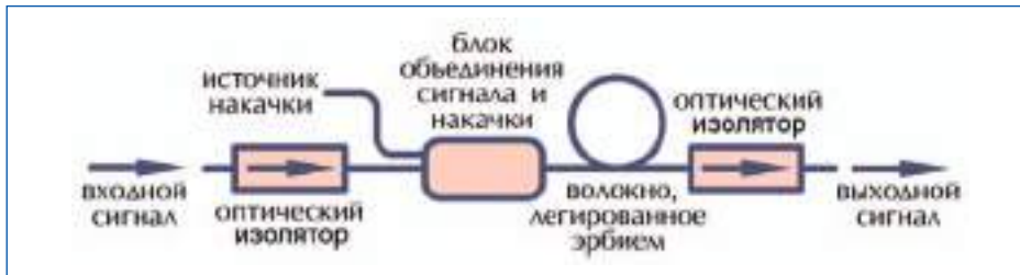
Рис.3. Упрощенная схема эрбиевого волоконного усилителя
