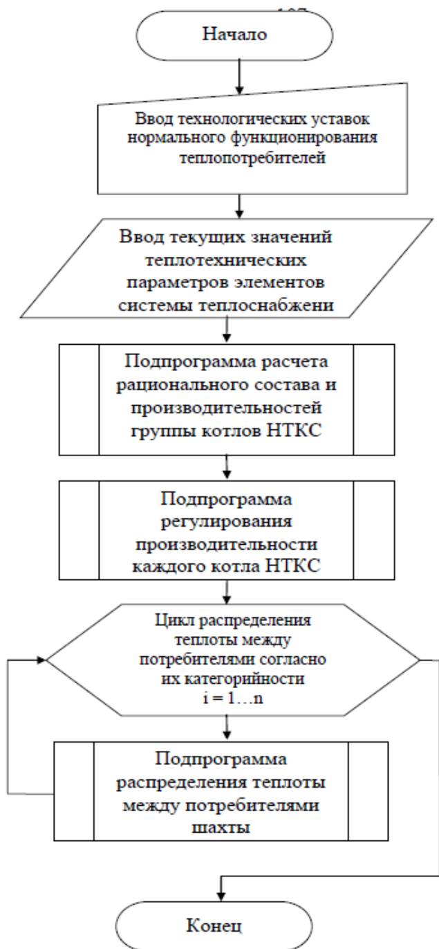
Рисунок 2 – Блок-схема алгоритма работы системы автоматического управления производством теплоты
