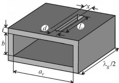
Рис. 3. Излучающий модуль
