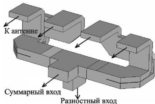
Рис. 8. Волноводный компаратор
