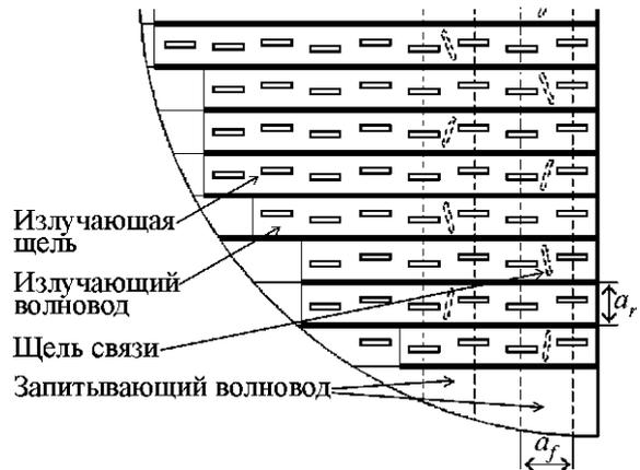
Рис. 1. Конструкция антенны (показана четверть антенны)
