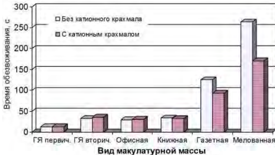
Рис. 5. Время обезвоживания бумажной массы из различных видов макулатуры (исходной и с добавлением катионного крахмала)
