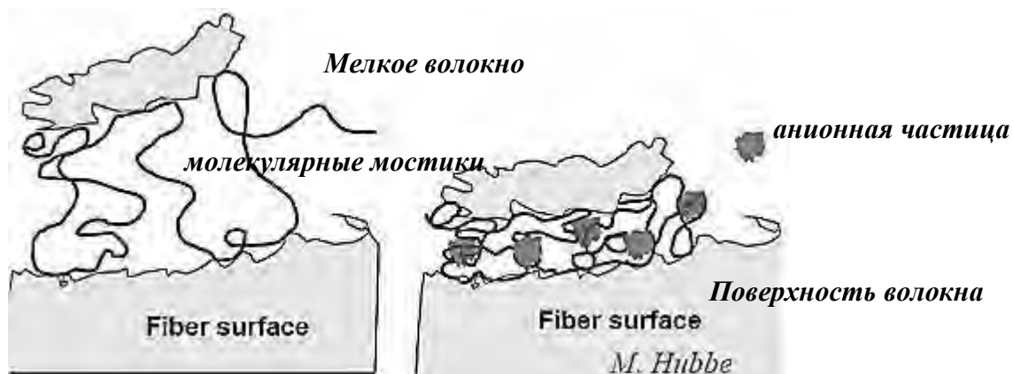
Рис. 3. Механизм действия микрочастиц в присутствии волокон
