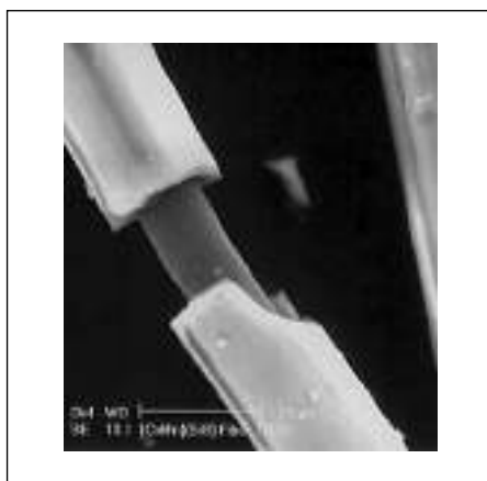
Рис. 2. Электронная микрофотография строения аморфного ферромагнитного микропровода в стеклянной изоляции (длина масштабного штриха на снимке — 20 мкм)
