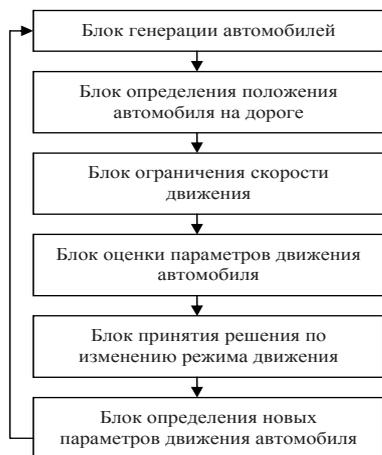
Рис. 2. Блок-схема алгоритма модели
