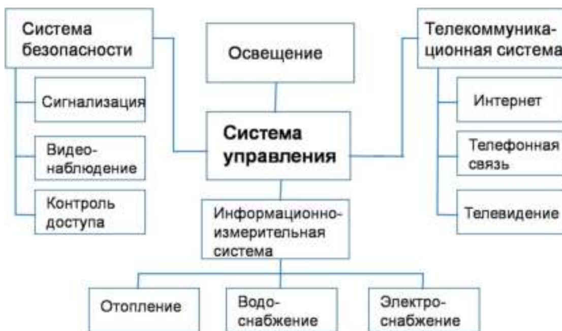
Рисунок 1 – Принципиальная структура "Умного дома"
