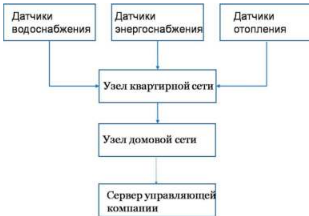
Рисунок 2 – Принципиальная схема информационно-измерительной подсистемы энергосбережения
